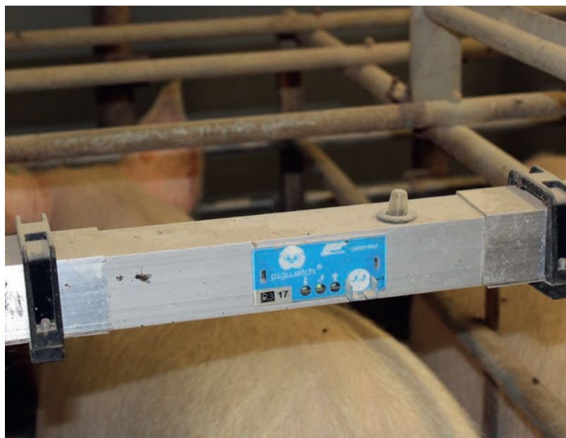
In de dekstal zitten onderaan een metalen balk, die boven de rug van de zeugen doorloopt, bewegingssensoren. Een aantal lichtjes op de balk geven de varkenshouder de vereiste signalen.
