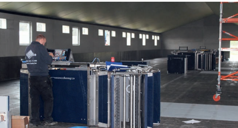
Per groep zijn er drie sorteersluizen voorzien. Die zijn van fabrikant Nedap, naar verluidt een primeur voor België.
